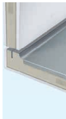
Die Wand- und Deckenpaneelen sind aus verzinktem und weiß lackiertem Stahlblech in Sandwich-Bauweise mit Nut- und Federsystem hergestellt. Die Isolierung besteht aus 80 Millimeter starkem hartem Polyurethan-Schaum (PUR-Schaum) mit einem K-Wert von 0,29W je Quadratmeter. Gegen Mehrpreis stehen auch Paneelen mit schwer entflammbarem PIR-Schaum zur Verfügung.
