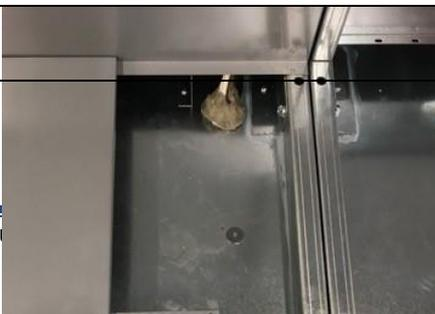
Entfernen Sie die Bodenplatten und bewegen Sie das Lufteinlassgitter, um einen leichteren Zugang zu den Kanalisierungslöchern in der Wanne zu erhalten.
