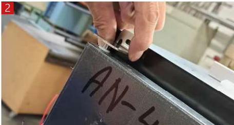
1 Drehen Sie – bei geschlossener Tür – die 3 Schrauben heraus und 2 ziehen das Scharnier nach oben heraus.
