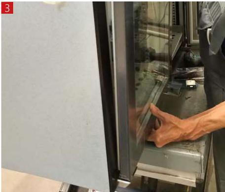
3 Öffnen Sie die Tür und ziehen diese aus dem unteren Scharnier nach oben heraus.
