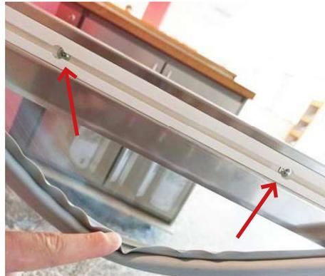
Öffnen Sie den Zug und ziehen die Dichtung am oberen Rand ab. Unter bzw. hinter der Dichtung befinden sich die Schrauben, die den Bügel- / Segmentbogengriff fixieren.
