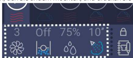
Durch erneutes Drehen wird der Wert des ausgewählten Parameters eingestellt und durch Drücken des Drehknopfs bestätigt.
