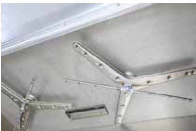
Effizient: Zweifach-Spülarme und Ablaufkanal für die Wärmerückgewinnung.
